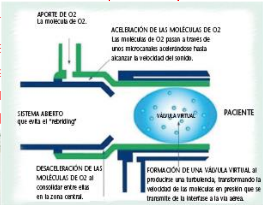
Figura 7. Mecanismo valvular virtual de la CPAP (presión positiva continua en la vía aérea) de Boussignac.
